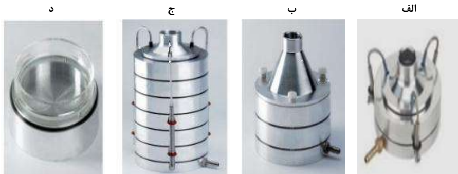
الف) اندرسون تک مرحله‌ای ب) اندرسون دو مرحله‌ای ج) اندرسون شش مرحله‌ای د) نمونه‌ای از صفحات مورد استفاده در نمونه‌بردار اندرسون شکل ۴-۳: نمونه‌بردارهای اندرسون
